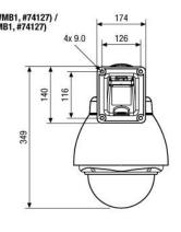
Wandmontage (inkl. Anschlussbox mit Netzgerät und Montagearm EDC-AKS-1, #74125) / Wall mount (incl. power & connection box with mounting bracket EDC-AKS-1, #74125)
