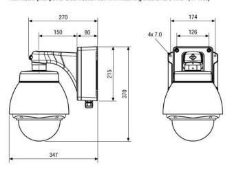
Der Wandmontagearm, die Deckenhalterung und die Anschlussbox mit Netzgerät sind im Lieferumfang des Domegehäuses nicht enthalten. Wall bracket, ceiling tube and power & connection box are not included with the dome camera housing.
